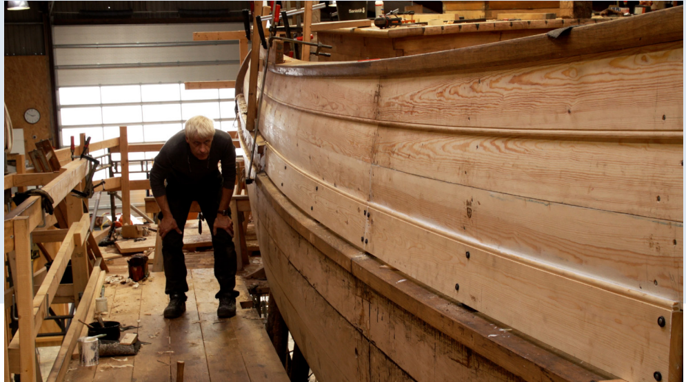
Skanseklædning færdig - de to midsterse planker klades spejlet
