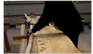
Trækstok sættes efter rigpunkter
