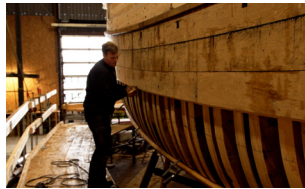
Spanter er slethøvlet
